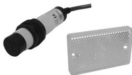
Sensores fotoelétricos por luz infra-vermelha são dispositivos ativos, usados para comutar circuitos elétricos e eletrônicos de potência reduzida, sempre que algum objeto interromper seu feixe de luz.
