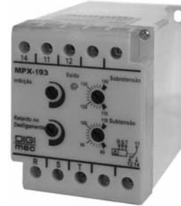
Com a entrada de alimentação auxiliar energizada e a entrada de supervisão com as três fases R, S, T em sequência correta e com a tensão normal, o relé de saída comuta seus contatos para a posição de trabalho, retornando para a posição de repouso quando ocorrer uma ou mais situações abaixo:
