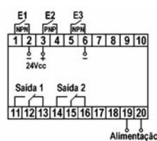
Exemplo SCM (CCM, FCM e RCM): Seguir especificação dos bornes no diagrama de ligação)
