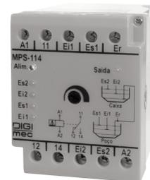
O relé de nível eletrônico microprocessado tipo MPS-114 foi desenvolvido para controle e/ou supervisão automática do nível de líquidos condutores de corrente elétrica, comandando solenóides, contadores de moto-bombas ou simplesmente alarmes luminosos e/ou sonoros. Montado em caixa plástica de ABS, compacto, apresentando alta resistência à choques, vibrações e alta imunidade à ruídos elétricos, além de possuir um sistema de fácil fixação em trilho DIN ou por parafusos.
