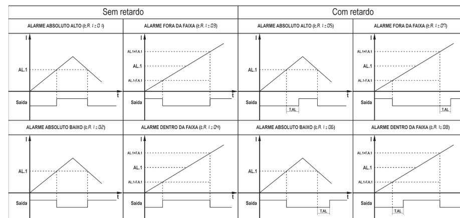
OBS. 1. Os tipos de alarme 11, 12, 13 e 14 são idênticos respectivamente aos tipos 1, 2, 3 e 4, porém com a função inibição: a saída permanecerá desligada até o valor de corrente ter atingido uma vez o set-point, após isto a saída dependerá das condições de alarme.
