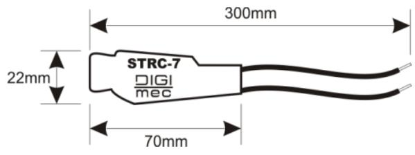
Figura 4 Esquema supressor de ruído elétrico e dimensões.
