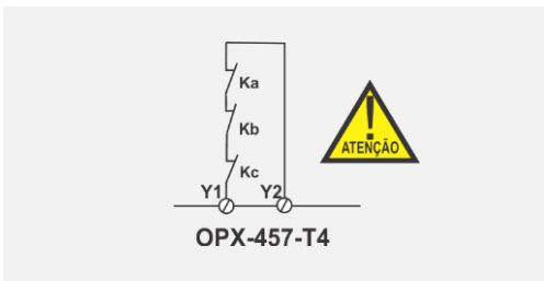
Figura 11 - Intertravamento com elo de realimentação dos contatores externos e jumper de rearme automático
